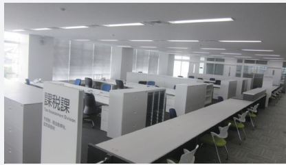
◀自然光により照度を調整する明るさセンサーを設置し、ムダな照明エネルギーを削減。また、執務室は、人数の増減など、機構改革に合わせて柔軟に対応できる合理的な「ユニバーサルプラン」を採用。
