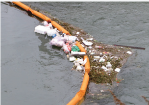
▲川でのごみ実態調査。川の支流が本流に合流するところにネットフエンスを張り、流れてくるごみを回収。
