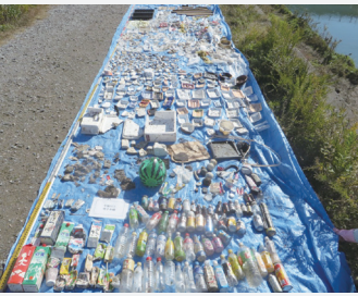
▲川でのごみ実態調査。川の支流が本流に合流するところにネットフエンスを張り、流れてくるごみを回収。
